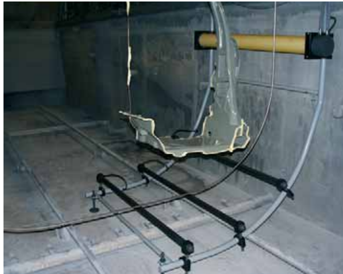
Bild 5. Systemzelle bestehend aus freien Bodenanoden und Dialysezellen
