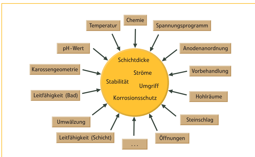
Bild 4. In der kathodischen Tauchlackierung gibt es eine Vielzahl von Einflüssen, die in realen Becken miteinander wechselwirken. In der Simulation lassen sich die einzelnen Einflüsse untersuchen und so gezielt optimale Parameter finden
