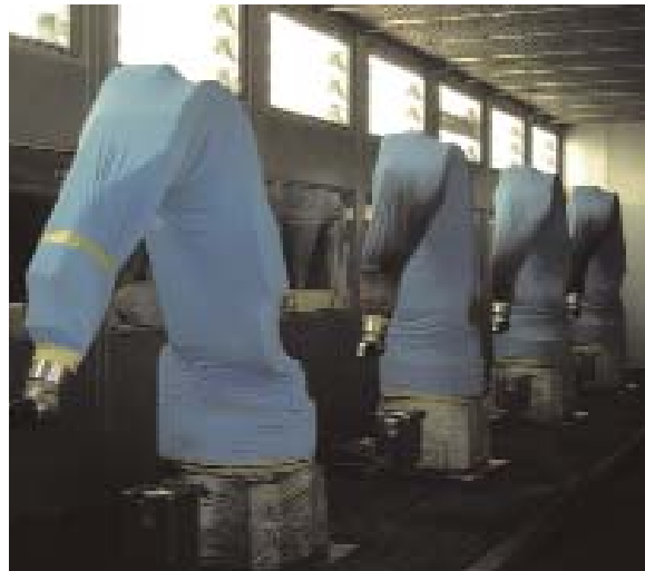
Bild 2: Roboter-Lackierkabine zur Wasserbasislack-Applikation ohne Primer
