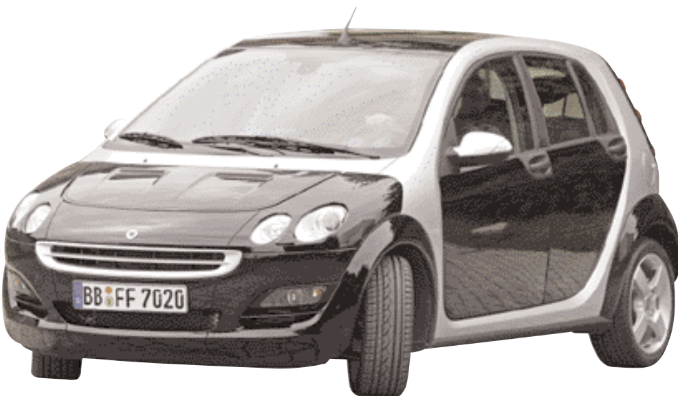
Bild 1: Smart „forfour“ mit silberner Tridion-Sicherheitszelle aus Metall und schwarzen Kunststoff-Bodypanels (Quelle: Smart)
