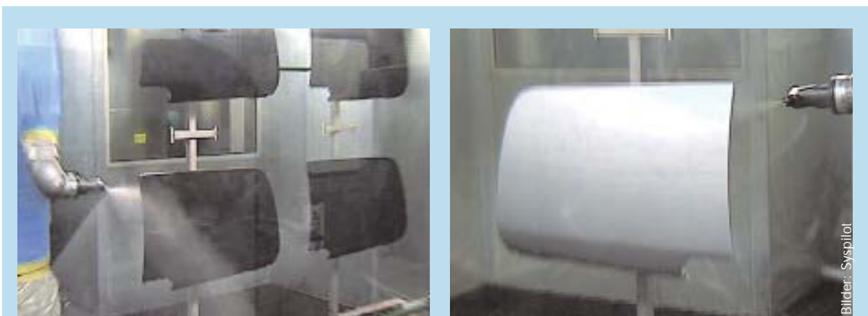
Bild 4: Bereits anhand des Sprühstrahls erkennt man wesentliche Unterschiede im Overspray-Anteil zwischen beiden Programmen. Bei dem „geteachten“ Programm (links) wären noch einige Optimierungszyklen bis zu einer hochwertigen Lackierung notwendig gewesen. Bei der ersten Lackierung mit offline erstellten Programmen (rechts) waren nur noch schnell durchführbare, punktuelle Optimierungen notwendig.
